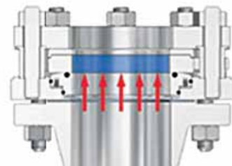
Uszczelnienie w warunkach nadciśnienia
