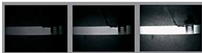
Rzeczywiste temperatury pręta wskazywane przez kamerę VIS THERMAL VISION™ 400°C-1575°C
